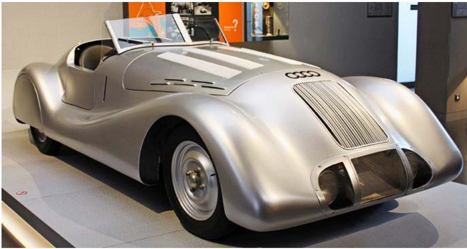
Der Wanderer W25 wurde für die Nonstop-Fernfahrt Lüttich-Rom-Lüttich gebaut und erreichte mit 60 PS 130 km/h
