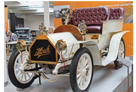
Der erste in Zwickau gebaute Horch aus dem Jahr 1904, ein Vierzylinder 14–17 PS leistender kutschenähnlicher Wagen
